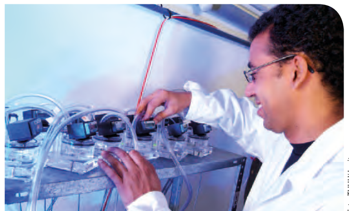
Anaerobes Testsystem zur Bestimmung von Biogaspotenzial an der TUHH
