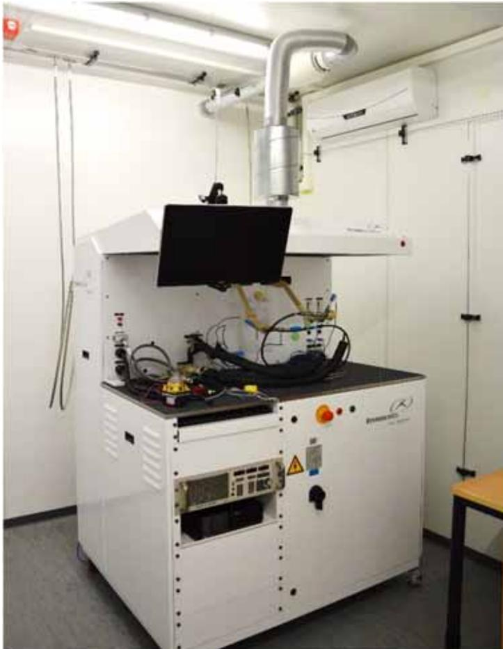
Einzelzellenteststand bis 2 kW;
