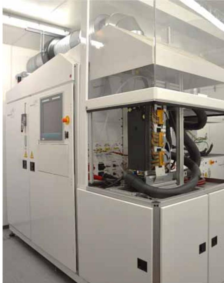
Initialisierungsteststand bis 12 kW
